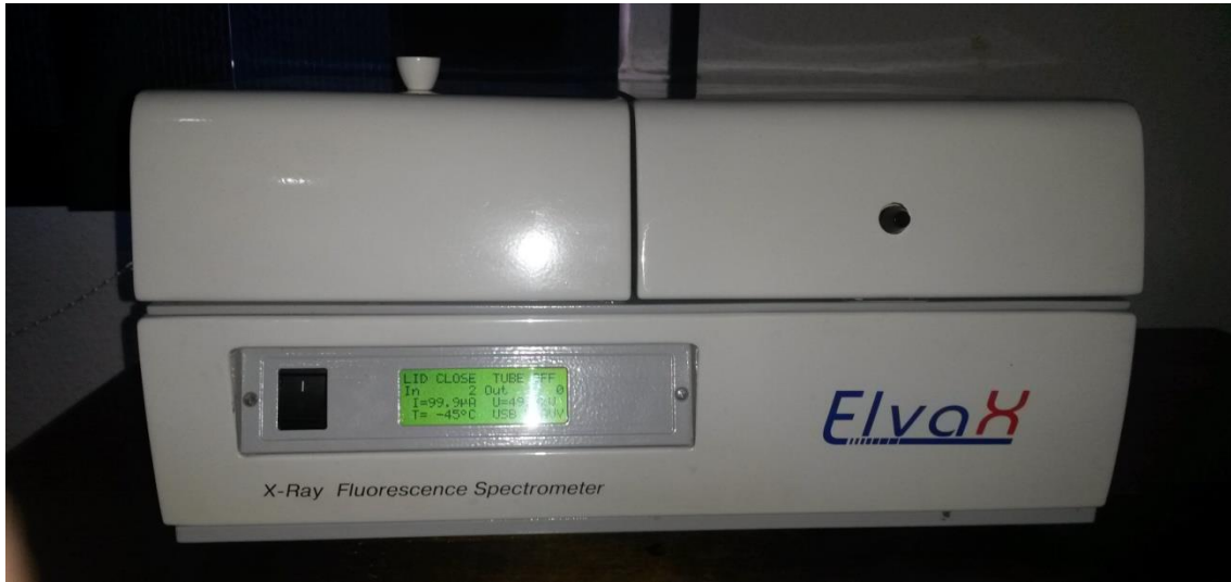
სურათი 1. ენერგო-დისპერსიული რენტგენულ-ფლუორესცენტული სპექტრომეტრი
