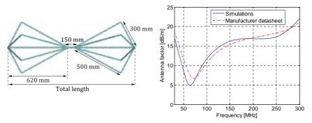
Fig. 20. Test antenna dimensions
