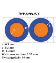
Fig. 40. Twisted-pair cable
