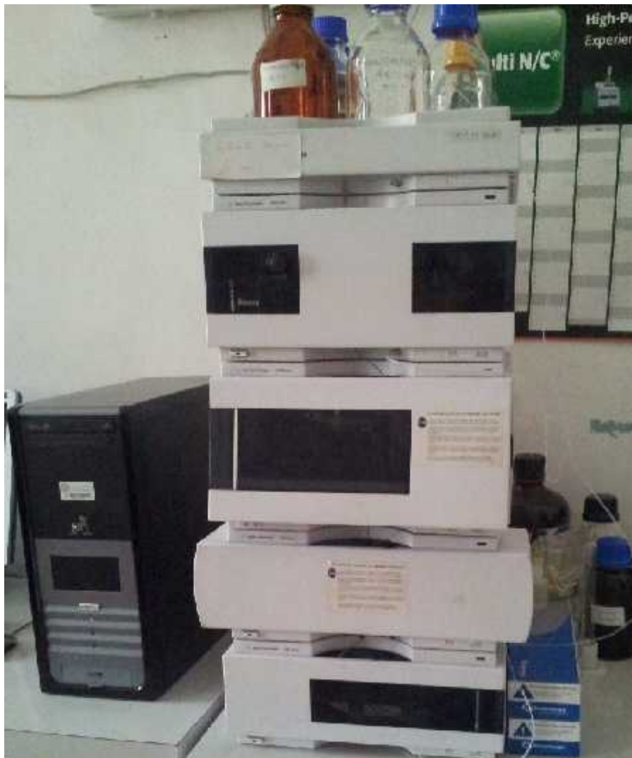
სურათი 1. Agilent 1200 სერიის ქრომატოგრაფი
